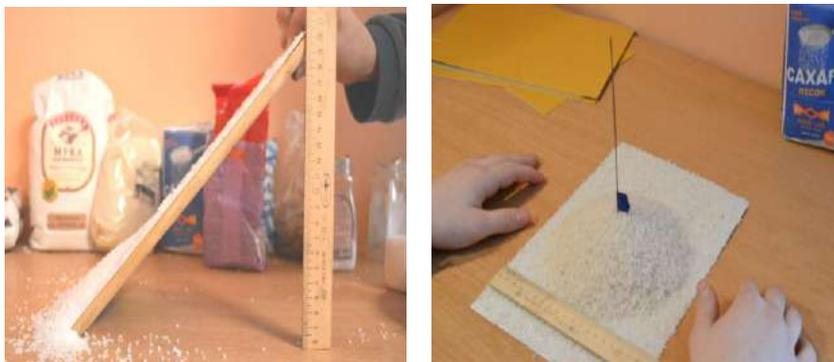
*Рис. 1. Эксперимент по определению коэффициента трения сыпучих материалов*
