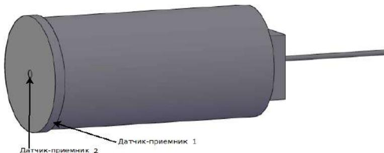
**Рисунок II – Рекомендуемое расположение датчиков-приемников на ультразвуковом скальпеле**
